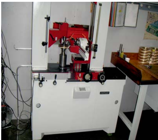
Höfler ZW400 für die Schneckenprüfung. Das Gerät wurde komplett zerlegt, geschliffen und lackiert sowie mit neuer Elektronik zum Anschluss an einen PC ausgestattet.
