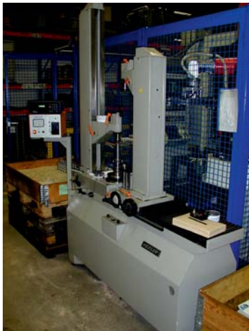
Höfler ZW630 für Stirnradprüfung. Das Gerät wurde repariert und ein neuer Antriebsmotor eingesetzt. Der Höko-Graph wurde ausgetauscht.
