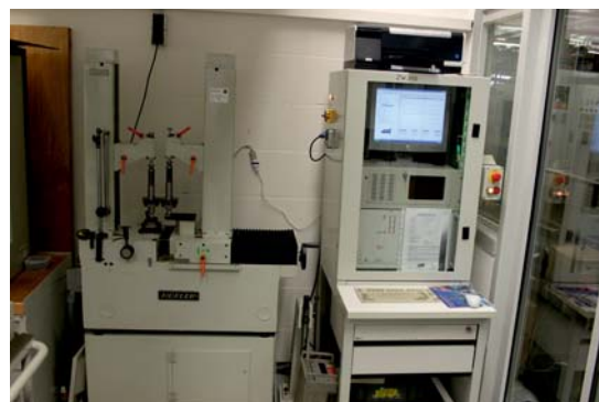
Höfler ZW300 für Stirnradprüfung. Das Gerät wurde mit einer neuen Messtechnik ausgestattet. Der PC und die Messelektronik wurde in den vorhandenen Elektronikschrank integriert.
