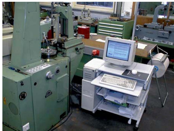
Höfler ZW der ersten Generation zum Prüfen von Stirnräder. Sehr massives Maschinenbett, auch für schwere Stirnräder einsetzbar. Bei diesem Gerät wurde der Antrieb und die Messtechnik mit neuer Elektronik zum Anschluss an einen PC ausgestattet.
