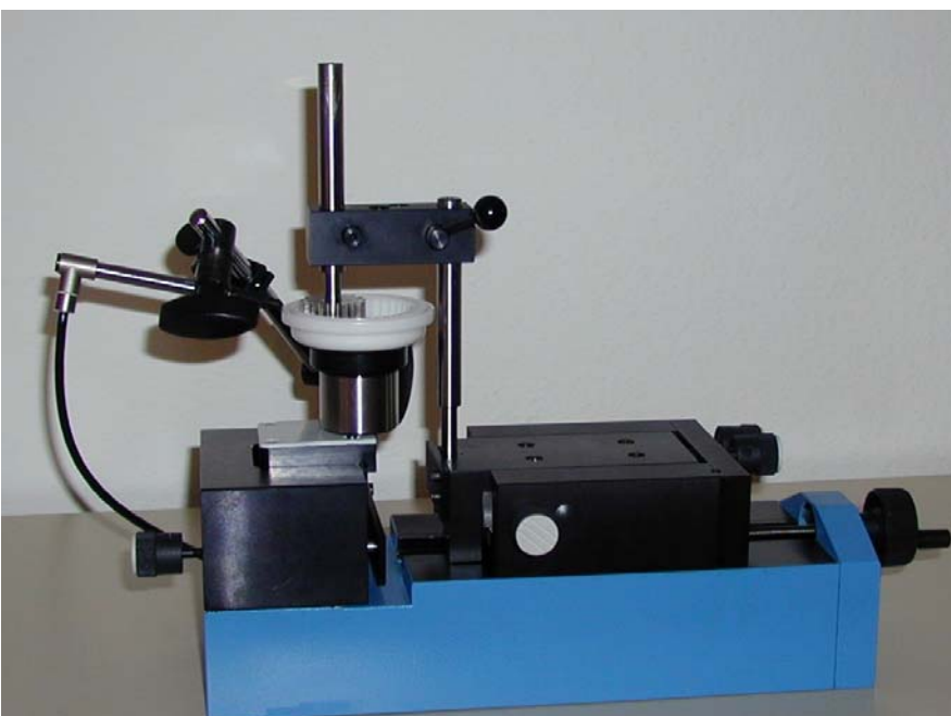
ZWG100H für Innenverzahnung und zusätzlichem Messtaster zur Kompensation des Aufspannfehlers
